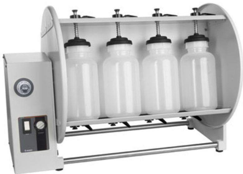
Шейкер Reax 20 фирмы Heidolph с переворотным механизмом на 4 сосуда
