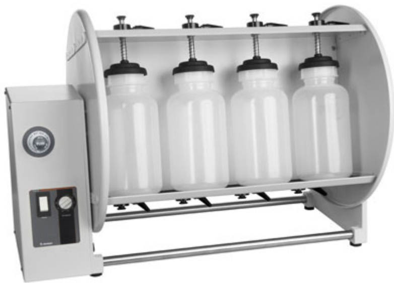
Шейкер Reax 20 фирмы Heidolph с переворотным механизмом на 12 сосуда
